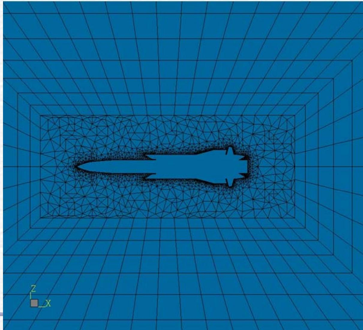
Фрагмент треугольной сетки на поверхности изделия
