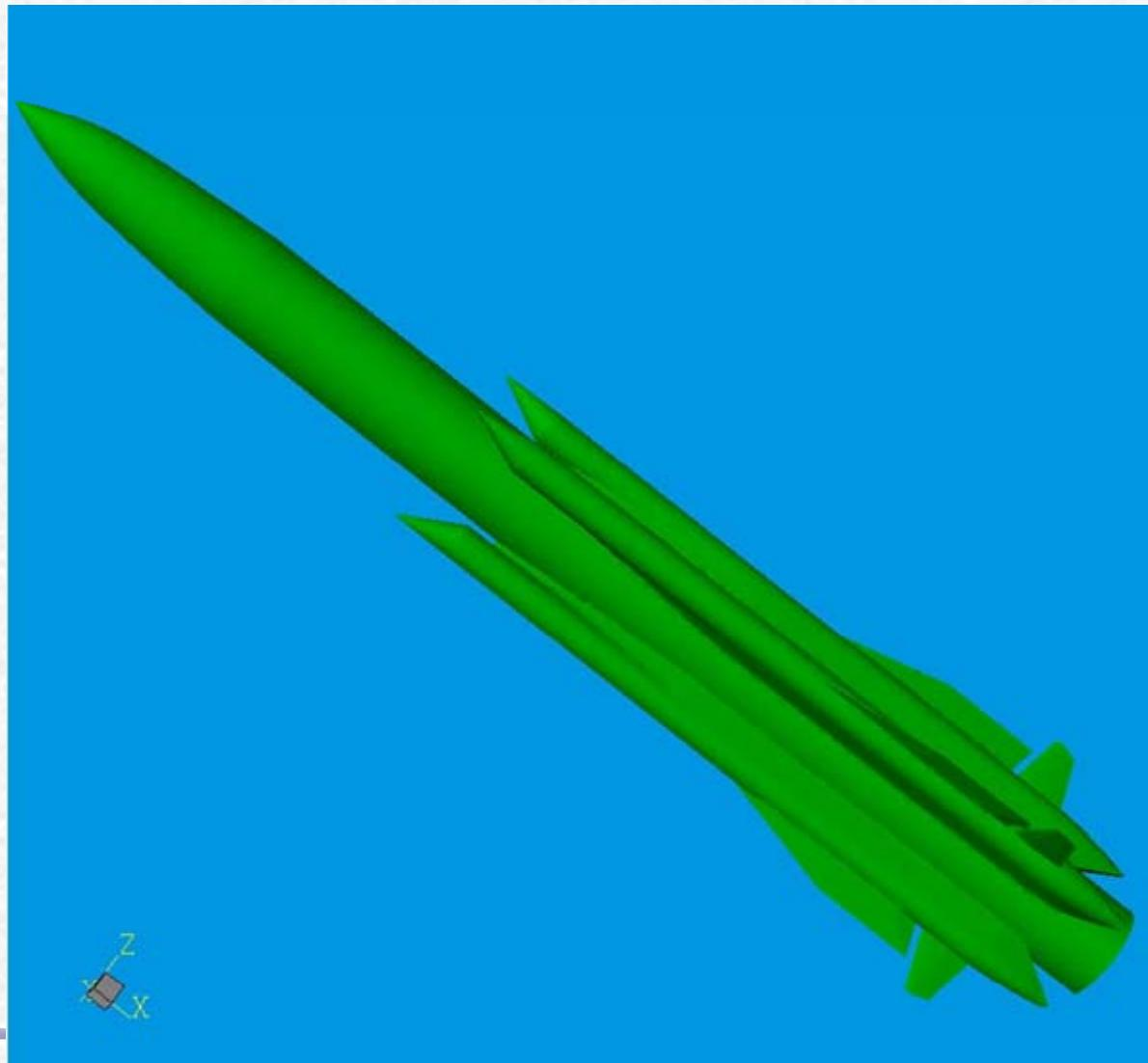
Построена пространственная неструктурированная гибридная сетка, состоящая из 107 607 узлов, 494 768 ячеек (485 248 тетраэдров, 9 044 гексаэдра, 476 пирамид), при этом на поверхности рассчитываемого изделия генерировалась треугольная сетка.
