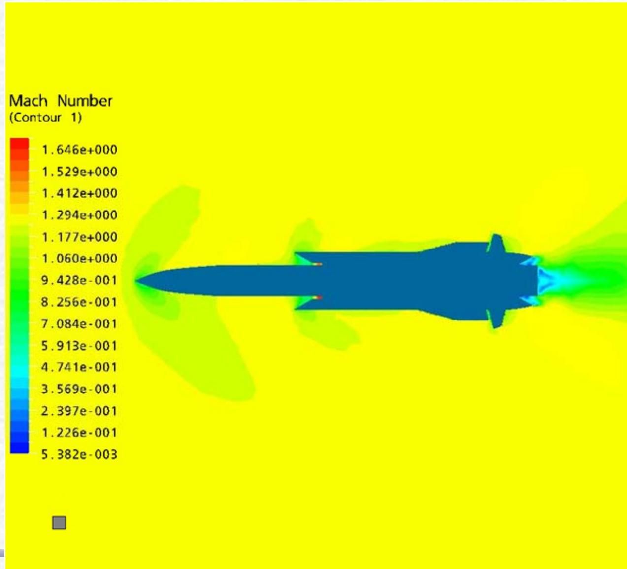
$M=3.0, \alpha=6^\circ$  Распределение чисел Маха в плоскости симметрии
